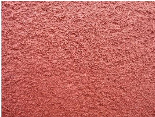
Antislippoppervlak van InFloor® AQ POX roll SRT > 70
